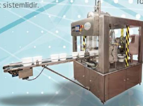
DLS 2160 R 2000 kase/saat kapasiteli rotary Full otomatik ikili yoğurt sütü dolum ve kapama makinesi
