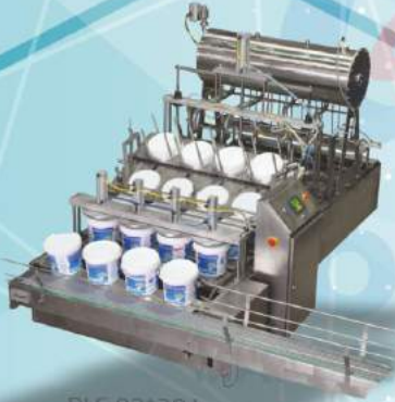
DLS 02*20 L 5000 kg/saat dolum kapasiteli lineer Full otomatik yoğurt sütü kova dolum makinesi. 2 kg' dan 20 kg' a kadar ayrı ayrı kovaları dolum yapabilme özelliğine sahiptir.
