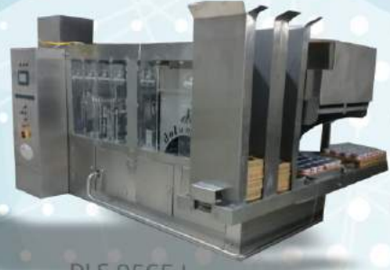
DLS 9565 L 6500 kase/saat kapasiteli lineer full otomatik altılı Ø95 mm ayran dolum makinesi robot toplama ünitesi.
