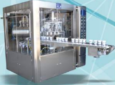
DLS 7545 R 4500 kase/saat kapasiteli Rotary Full otomatik dördütlü Ø75 mm ayran dolum makinesi
